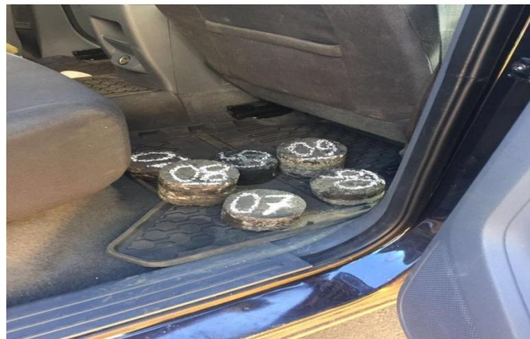
Foram retiradas amostras para testes de GRANULOMETRIA e TEOR DE BETUME
